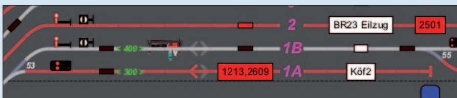
In iTrain werden sowohl die Köf II als Zug im weißen Feld angezeigt, wie auch deren Adresse und die des vierachsigen Umbauwagens, der über einen RailCom-fähigen Decoder verfügt.
