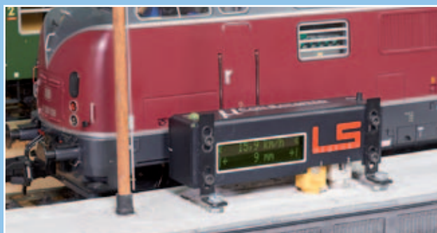
In Verbindung mit iTrain wird die Lok über eine Auswahl von Fahrstufen an dem \mu Con-Railspeed-Modul vorbeifahren und die Messwerte der einzelnen Fahrstufen von iTrain für die Steuerung der Fahrzeuge übernommen.
