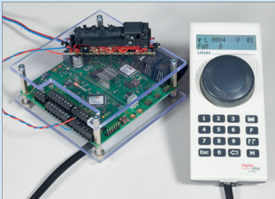
Minimalausstattung zum Fahren: Netzteil (nicht im Bild), GBMboost und Handregler LH101 von Lenz. Das Modul GBMboost ist nur ohne Gehäuse erhältlich und hier vom Autoren zwischen zwei Acrylglasplatten montiert. Der integrierte, railcomfähige Besetzmelder überwacht 16 Gleisabschnitte. Leider wird die Adressrückmeldung nicht an den angeschlossenen Handregler übertragen. Das erfolgt im Zusammenspiel mit Steuerungsprogrammen.
