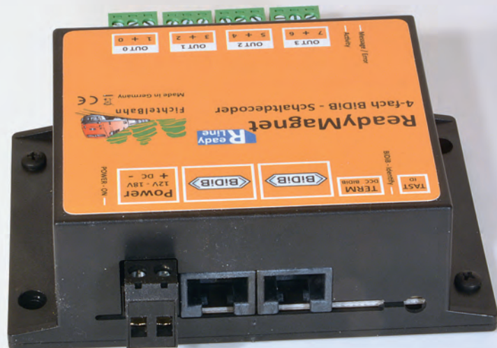
Die Anschlussseite im rechten Bild zeigt neben den beiden Busanschlüssen und dem Stromversorgungsanschluss auch die Jumper für die Buserminierung, die beim ersten und letzten Baustein eines BiDiBus aufgesteckt werden müssen. Hinzu kommen die beiden etwas versteckten LED-Anzeigen für Stromversorgung und Busaktivität
