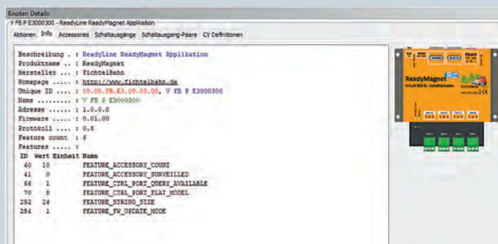
Im Reiter „Info“ des BiDiB-Wizard sind die Knotendetails dargestellt
