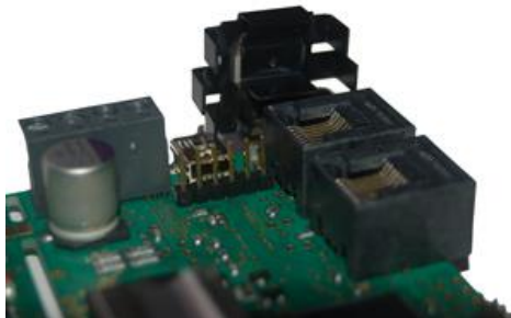
Abbildung 19: GBMboost v1.8 Kühlblech
