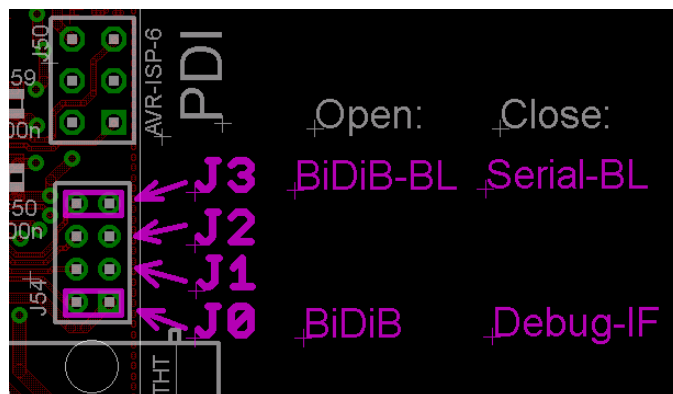
Abbildung 38: GBMboost Bootloader Jumper
