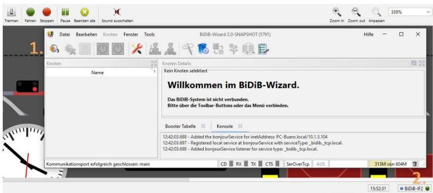
Jetzt kann der Wizard über das Steuerungsprogramm verbunden werden (1.) und alle BiDiB-Baugruppen werden in der Knotenliste angezeigt. Die Voraussetzung ist, dass iTrain eine Verbindung mit der Hardware (2.) aufgebaut hat.
