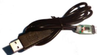
Schließen Sie das Updatekabel an einem freien USB-Port Ihres PCs an. Der FeedCarV2 wird mit dem Updatekabel verbunden und dann **erst die 5V Betriebsspannung angelegt**. Die rote LED auf dem FeedCarV2 blinkt jetzt permanent. Anschließend starten Sie am PC das AVRRootloader-Tool, definieren unter Port den richtigen COM-Port und stellen die Baudrate auf 9600 Baud ein. Mit einem Mausklick auf die Schaltfläche „Connect“ wird jetzt eine Verbindung zum FeedCarV2 hergestellt.
