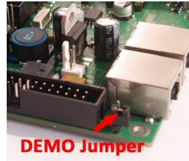
Die LightControl hat einen **SELF TEST** oder **DEMO Mode**, mit dessen Aktivierung alle Ports ein Lauflicht ausgeben. Mit dieser Funktion kann nach dem erfolgreichen Aufbau, alle Ausgänge der LightControl auf Ihre Funktion getestet werden.
