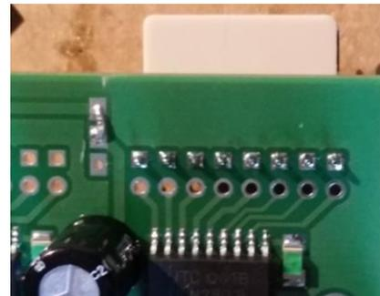
Nun stecken Sie von oben einen PSS 254/8G genau in die hintere Reihe und verlöten diesen von unten. Dies machen Sie bei allen 3 Gruppen, somit ergibt sich folgendes Bild:
