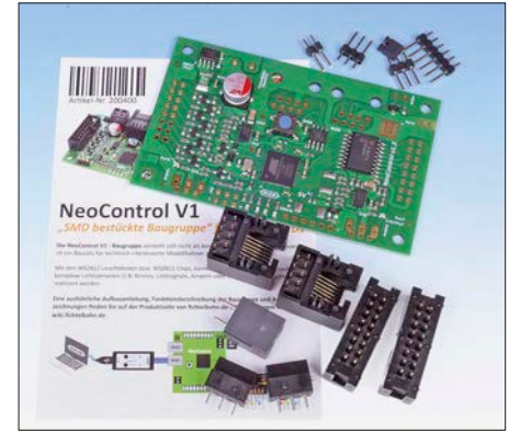
Der NeoControl wird als SMD-vorbestückter Bausatz angeboten und ist einsteigertauglich.
