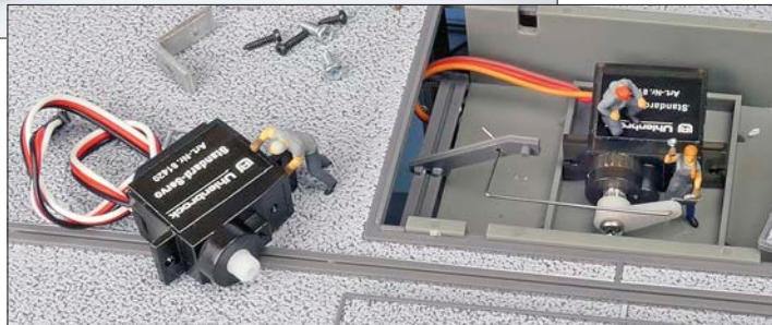
Servoantriebe eignen sich z.B. als vorbildnahe Torantriebe. Am ReadyServo8 können sowohl die Endpunkte als auch die Stellgeschwindigkeit und die Bewegungskurve eingestellt werden.
