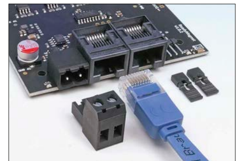
Auf der anderen Seite befinden sich die Anschlüsse für Netzteil, BiDiB und Busabschluss.
