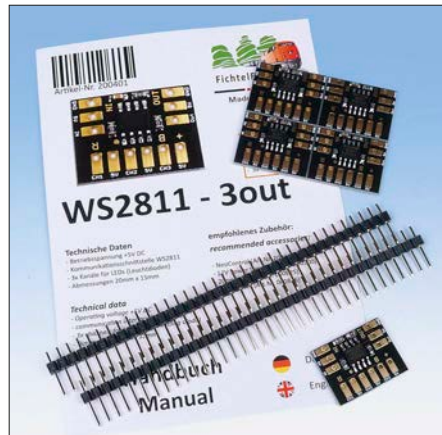
Mit dem WS2811-3out finden drei konventionelle LEDs am Datenbusstrang der LEDs Platz.
