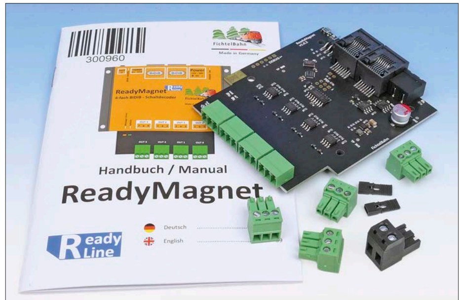
Der ReadyMagnet besitzt über Schraubklemmen Anschlüsse für vier Doppelspulantriebe oder alternativ acht andere Verbraucher. Jeder Ausgang darf dabei mit max. 1,2 A belastet werden.
