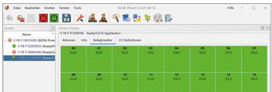
Der ReadyTLE16 wird, wie auch alle anderen Baugruppen im BiDiBus, nach dem Einstecken selbstständig erkannt und kann anschließend mit dem BiDiB-Wizard konfiguriert werden.
