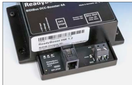
Auf der Front befinden sich die elektrischen Anschlüsse für einen Not-Aus-Taster mit Statusanzeige und den DCC-Fahrstrom.
