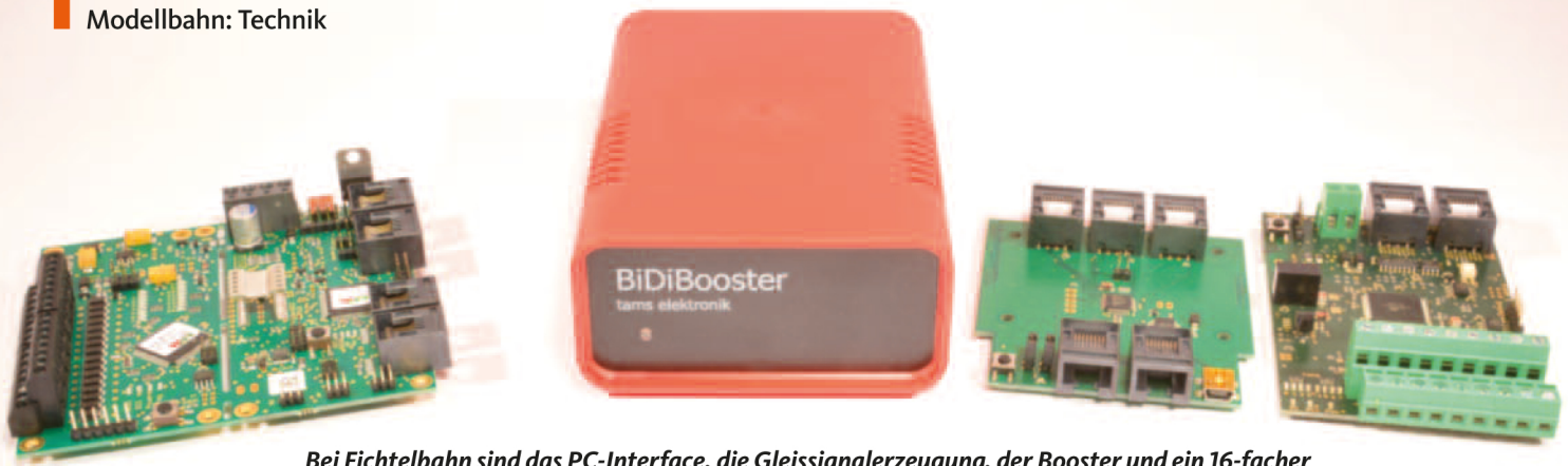
Bei Fichtelbahn sind das PC-Interface, die Gleissignalerzeugung, der Booster und ein 16-facher Besetztmelder auf einer Platine platziert (links); Tams setzt hingegen auf den modularen Aufbau mit einem Booster im Gehäuse, Interface/s88-Adapter und achtfachem Besetztmelder
