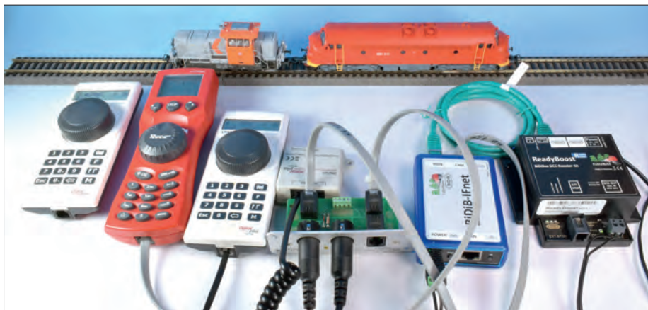
Ein Test mit mehreren Handreglern lief erfolgreich. Auch das LTM101 lief störungsfrei. Damit lassen sich auch bequem Funkhandregler wie der LH101-R von Lenz einsetzen.
