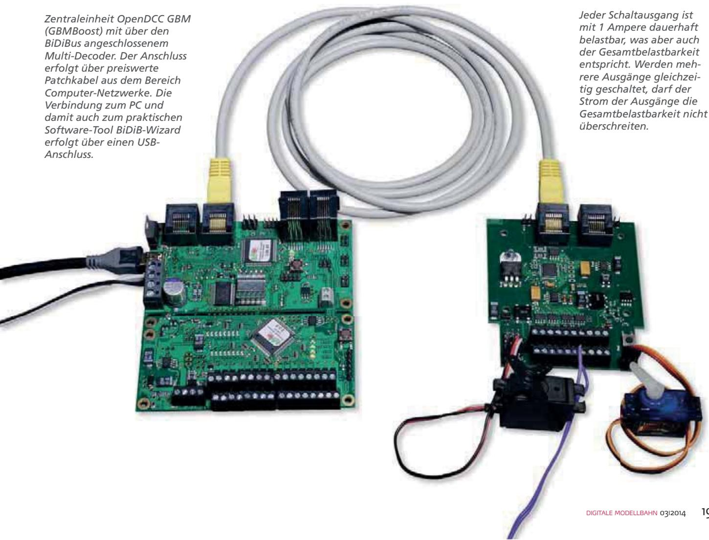
Jeder Schaltausgang ist mit 1 Ampere dauerhaft belastbar, was aber auch der Gesamtbelastbarkeit entspricht. Werden mehrere Ausgänge gleichzeitig geschaltet, darf der Strom der Ausgänge die Gesamtbelastbarkeit nicht überschreiten.
