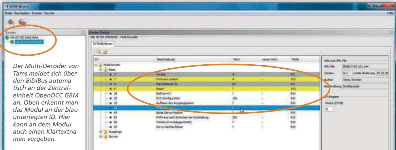
Der Multi-Decoder von Tams meldet sich über den BiDiBus automatisch an der Zentraleinheit OpenDCC GBM an. Oben erkennt man das Modul an der blau unterlegten ID. Hier kann an dem Modul auch einen Klartextnamen vergeben.
