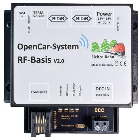
Die RF-Basis ist das „Radio Block Center“ für die Autos im OpenCar-System, die sich mit dieser per 2,4-GHz-Funk verbinden. Die Basis bringt einen direkten Anschluss für XpressNet und einen DCC-Sniffer mit.
