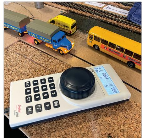
Mit einem XpressNet-Handregler wie diesem LH101 von Lenz lassen sich alle Fahrzeugfunktionen beherrschen. Die Fahrzeuge werden dafür auf unterschiedliche DCC-Adressen eingestellt.
