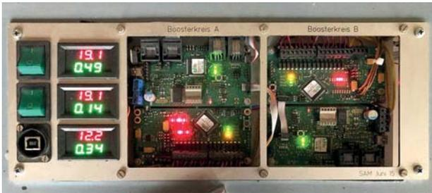
Die OpenDCC-Platinen bekamen einen Alurahmen mit Messgeräten. So ist der Betriebszustand jederzeit gut anhand der Status-LEDs auf den Platinen und den Strom- und Spannungsanzeigen ablesbar.
