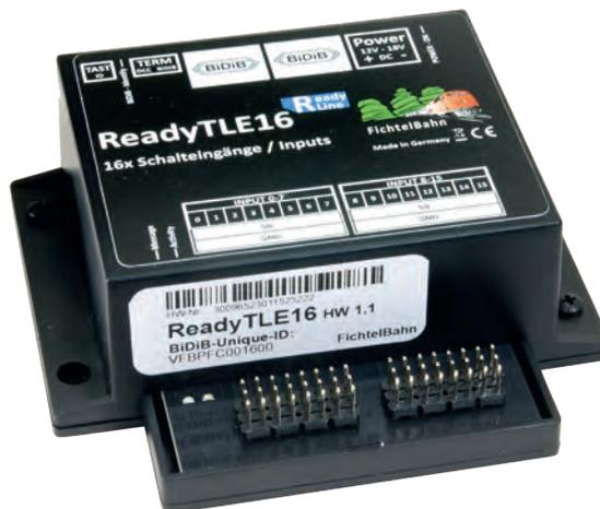
Der Rückmelder ReadyTLE16 ist nicht der klassische Baustein für die Gleisbesetzmeldung. Er ist konzipiert, um in den BiDi-Bus punktuelle Rückmeldungen z.B. von Weichenstellungen und Schaltgleisen einzuspeisen, sowie Sensoren von Car-Systemen zu überwachen. Er kann aber auch genutzt werden, um Taster von Aktionsknöpfen am Anlagenrand oder von konventionellen Gleisbildstellpulten in das BiDiB-System und eine Modellbahnsteuerung einzubinden.
