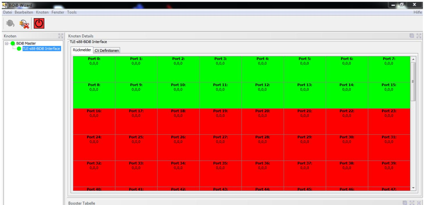
BiDiBus Master будет отображаться в виде интерфейса шины в списке узлов с левой стороны, также там появится и новый модуль **TLE-s88-BiDiB Interface**.
